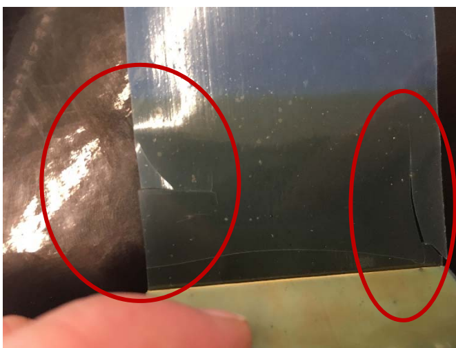
FIGUR 55. Knækket plast, for ældet PE-membran T7482-8.
