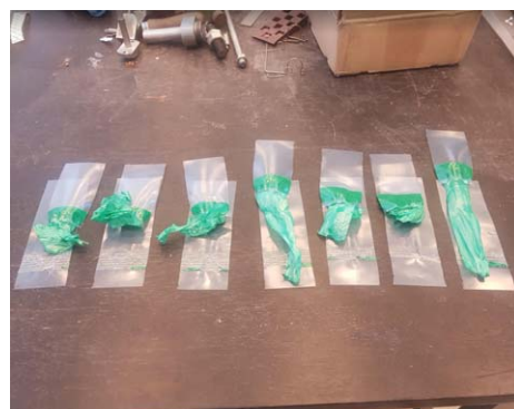
FIGUR 52. Afrivningsform for tapet samling. Billedet til venstre er PE-membransystem T7482-6 og billedet til højre er PE-membransystem T7482-4.
