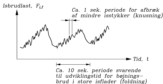
Figur 2.1. Illustration af lasthistorie ved isknusning mod en stor, stiv konstruktion.
